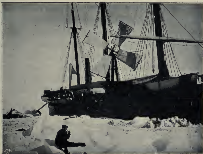
Aufnahme einer Sonnenhöhe zur Breitenbestimmung.
